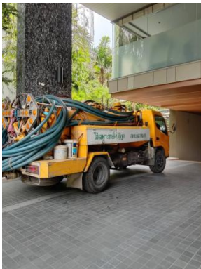
รูปที่ 2-51 การสูบตะกอนและสิ่งปฏิกูล
